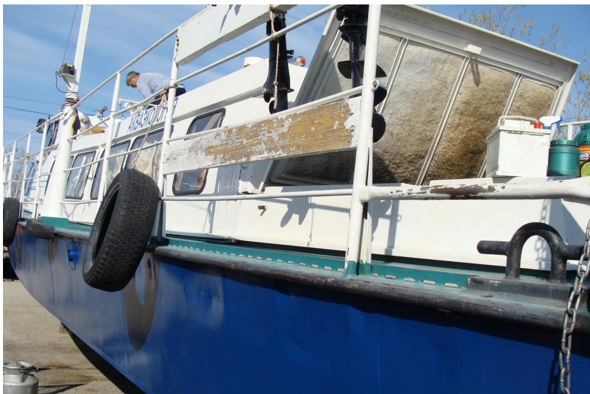
Рис.6 На 16.05.2014г. были покрашены днище, борта, шла покраска надстройки палубы.
